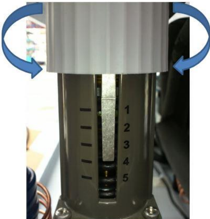
Image 3 Tournez la molette vers la valeur graduée 1 pour augmenter la quantité d'eau de refroidissement et tournez-le vers la valeur graduée 5 pour la réduire.
