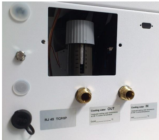
Image 2 Couvercle du régulateur de débit d'eau de refroidissement ouvert
